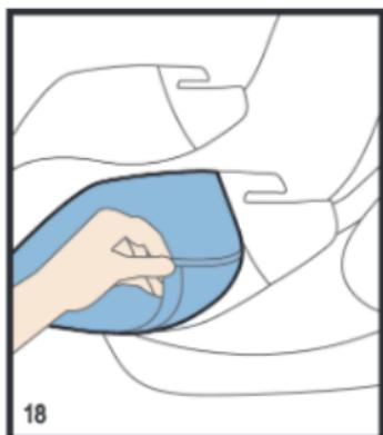
Suelte la funda del gancho y tire de ella hacia delante por debajo de la guía del cinturón central como se muestra en la imagen.
