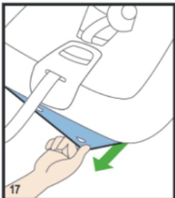
Détachez la housse au niveau des crochets, sur les bords de la coque.
