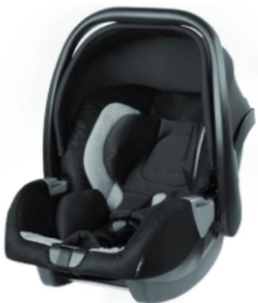
Primerno za uporabo le v tistih vozilih, ki so opremljena s 3-točkovnimi avtomobilskimi varnostnimi pasovi, ki so dovoljeni z uredbo ECE št. 16 ali drugimi primerljivimi standardi.
