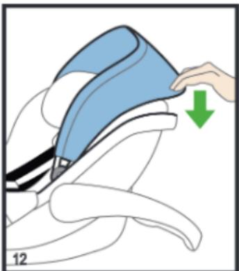
Puede presionar el extremo trasero de la capota en la hendidura correspondiente del portabebés como se muestra en la imagen.
