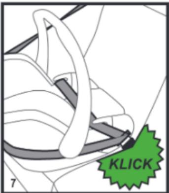
Ziehen Sie den Schultergurt weiter aus der Führung am Fahrzeug und legen Sie ihn um den Kopfbereich der Babyschale.
