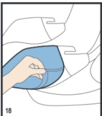
Lösen Sie den Bezug aus dem Haken und ziehen Sie ihn wie gezeigt unter der Beckengurtführung hervor.
