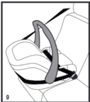
Dentro del vehículo, el asa de transporte debe encontrarse en posición vertical, como se muestra en la imagen.
