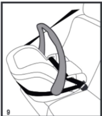
Dans le véhicule, la poignée de la coque pour bébé doit être placée à la verticale, comme illustré.
