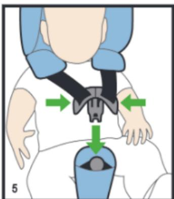
Проведите ремни через плечи ребенка вперед и положите язычки ремня друг на друга. Теперь вставьте язычки замка в корпус замка и зафиксируйте их со слышимым щелчком.
