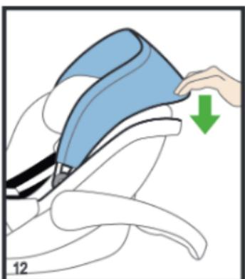
Le bord arrière du pare-soleil peut être enforcée comme illustré dans l'encoche prévue à cet effet dans la coque.
