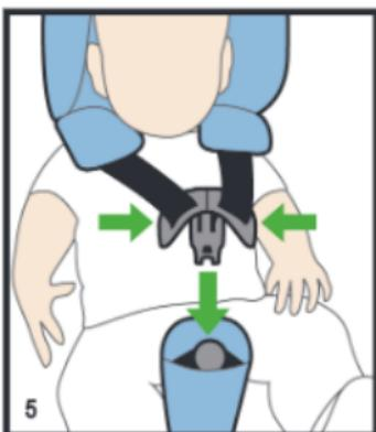
Проведіть ремені вперед над плечима дитини та з'єднайте язички застібок. Вставте язички застібок в корпус замка до ясно чутного кланцяння фіксатора.
