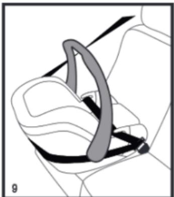
Etrierul de susținere trebuie să aibă poziție verticală în autovehicul, conform indicațiilor.
