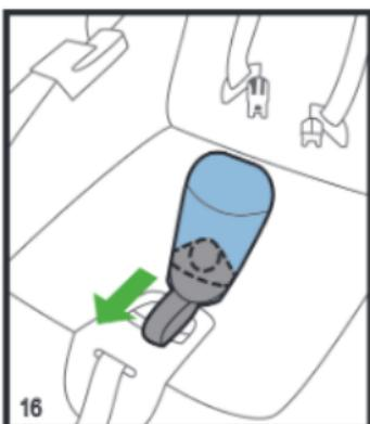
După aceea, trageti în jos mecanismele de blocare din perna închizătorului curelei.
