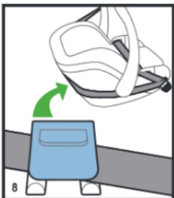
Estrarre la cinghia per le spalle dalla guida sull'autovettura e posizionarla attorno alla parte superiore del guscio portabebé. Spingere la leva blu sul retro verso l'alto e inserire la cinghia nelle guide come illustrato. A questo punto rilasciare la leva. Assicurarsi che la cinghia non venga compressa.
