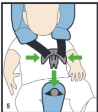
Ghidati centura peste umerii copilului către față și suprapuneți limbile curelelor. În continuare, ghidati limbile închizătorului în mecanismul închizătorului și blocați-le, moment în care trebuie să se audă un declic.
