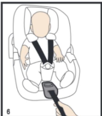
Straffen Sie den Gurt durch Ziehen am Verstellgurt. Je straffer der Gurt an Ihrem Kind anliegt, desto sicherer ist es in der Babyschale aufgehoben. Es ist deshalb zu empfehlen dicke Jacken oder Pullover im Fahrzeug auszuziehen.
